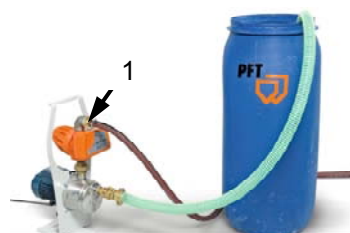
Rys. 34: Pompa podwyższająca ciśnienie
