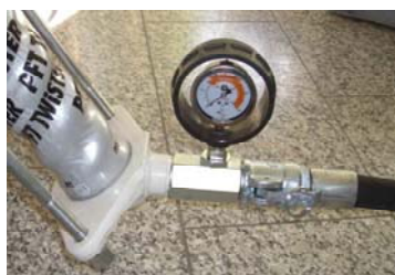
Rys. 76: Ciśnienie zaprawy na „0” bar.
