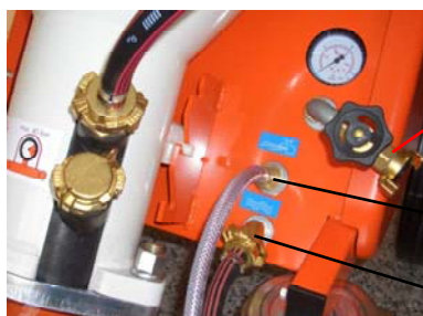
Rys. 10: Przyłącze wody i powietrza
