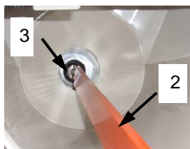
Rys. 61: Prawidłowe za mocowanie wału do czyszczenia
