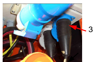
Rys. 70: Podłączyć wąż powietrzny
