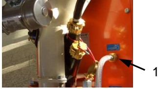
Rys. 42: Podłączyć wąż powietrza
