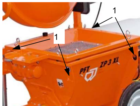
Rys. 16: Transport żurawiem / punkty mocowania
