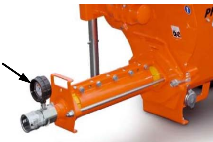
Rys. 24: Manometr ciśnienia zaprawy
