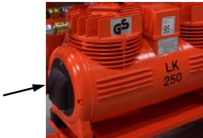
Rys. 50: Wymiana wkładu filtra
