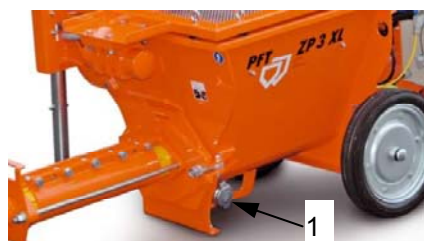
Rys. 44 Otworzyć pokrywę rewizyjną
